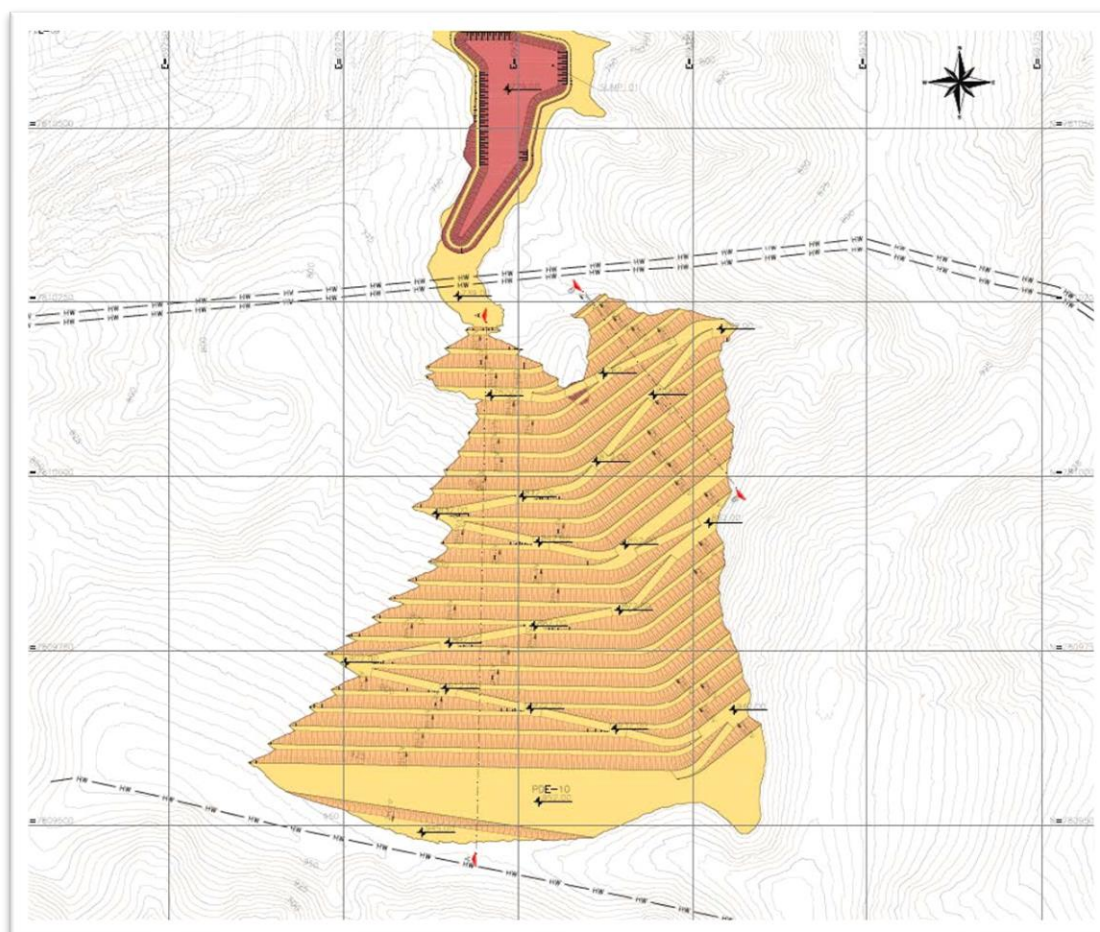
Figura 45 - Arranjo geral da PDE 10
