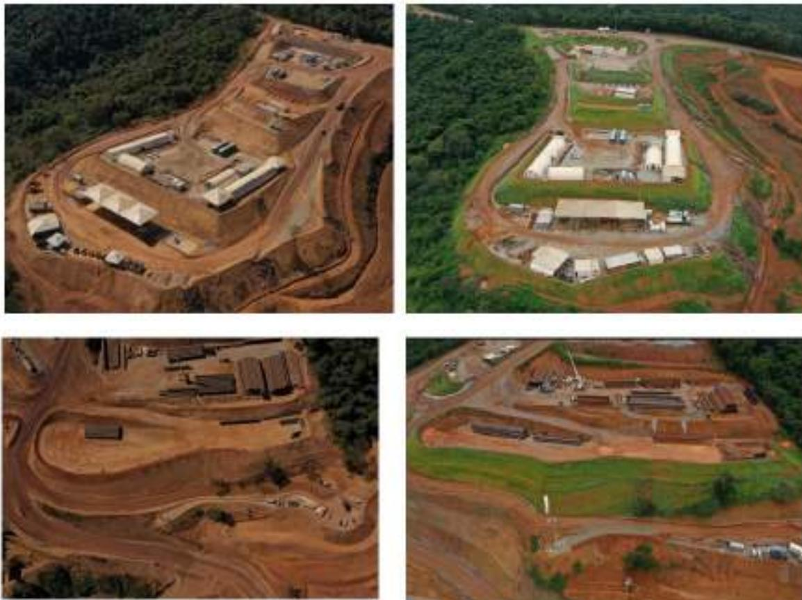
**Figura 15-28 - Recuperação de áreas de cortes e aterros em áreas de canteiro e estoque (antes e depois).**
