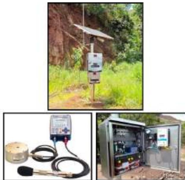
**Figura 15-38 - Sistema de monitoramento remoto e sismógrafo de engenharia.**
